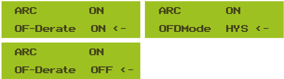
Abb. 8-1 Frq-Watt-Modus für Überfrequenzbedingungen
