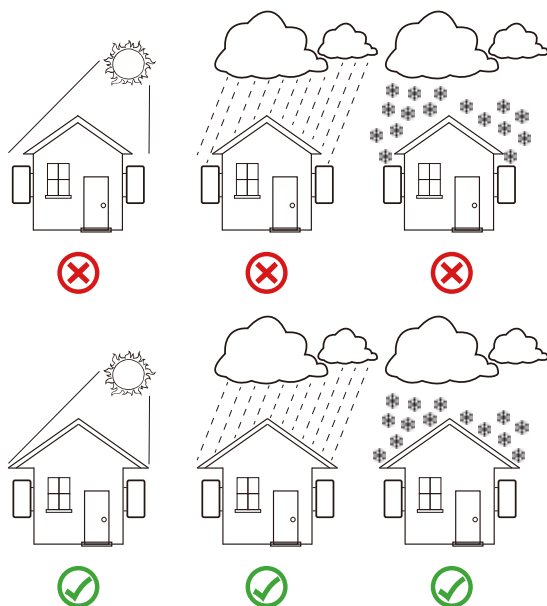
Rys. 4.1 Rekomendowane miejsca instalacji
